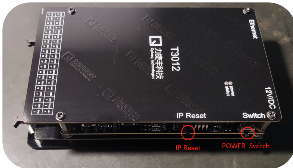
图 1.2: IP 地址复位按键及电源开关位置图
