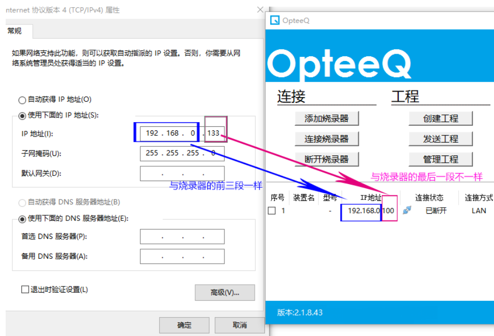
图4.8 计算机的IP地址与烧录器的IP地址对比
