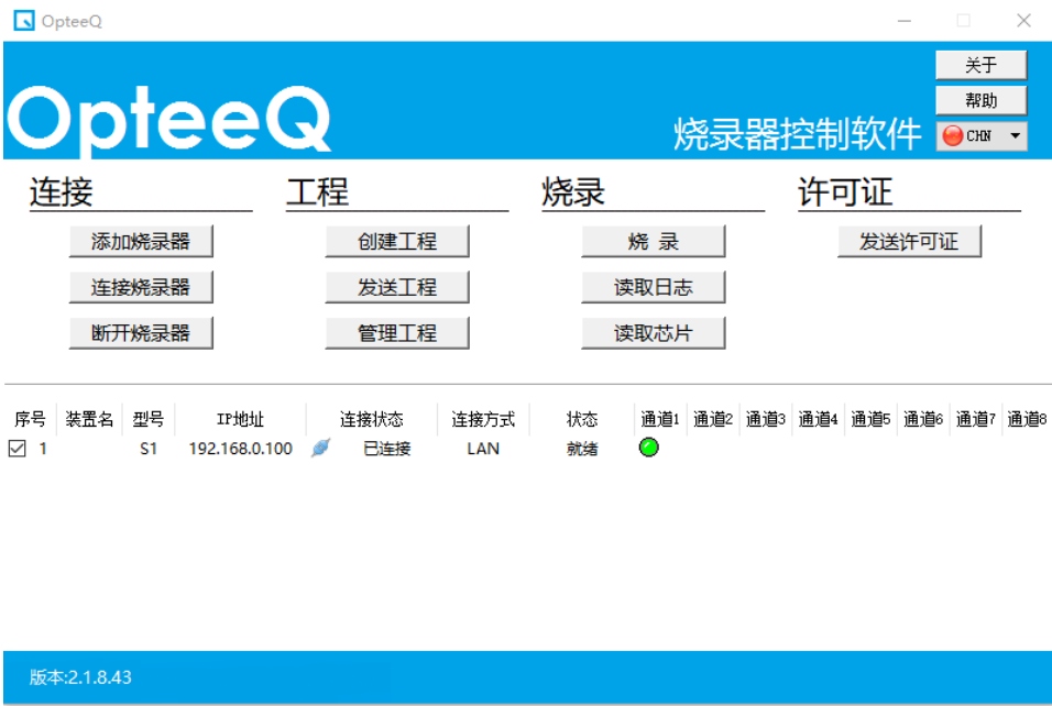
图4.10 成功连接上烧录器的显示界面
