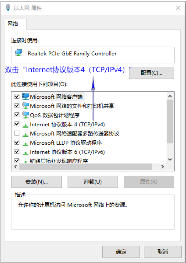
图4.6 修改计算机的IP地址，第3步
