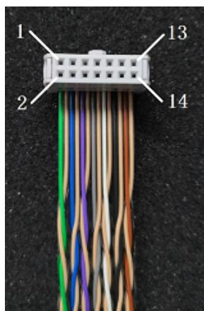
图7.2本公司提供的烧录线端口编号
