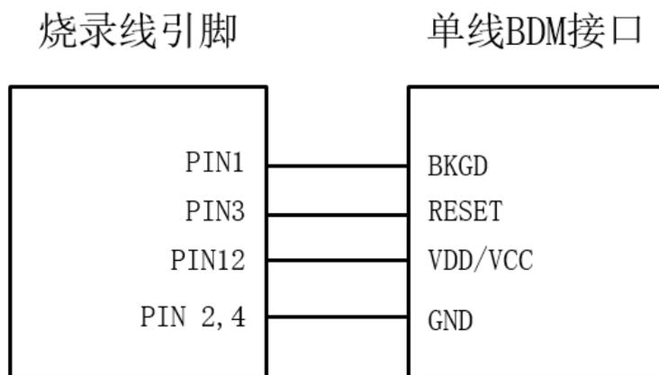
图7.7 S4/S8烧录线与单线BDM接口相连接
