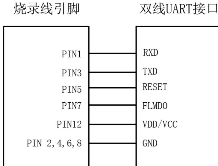
图7.9 S4/S8烧录线与双线UART接口相连接
