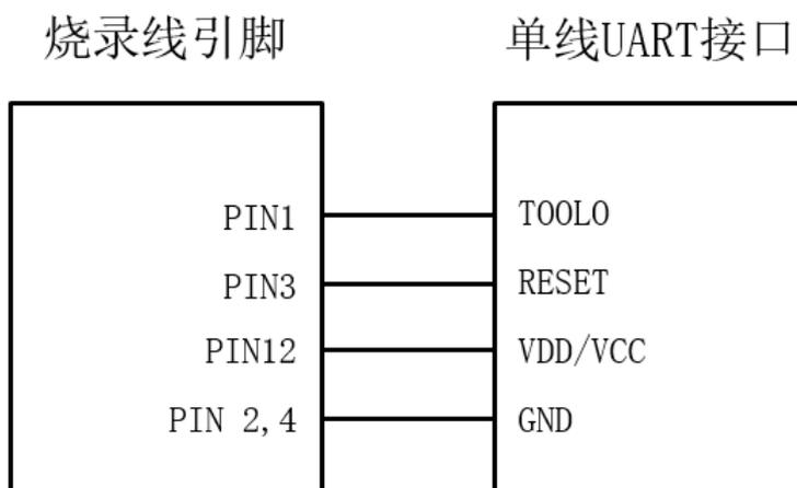
图7.16 S4/S8烧录线与单线UART接口相连接
