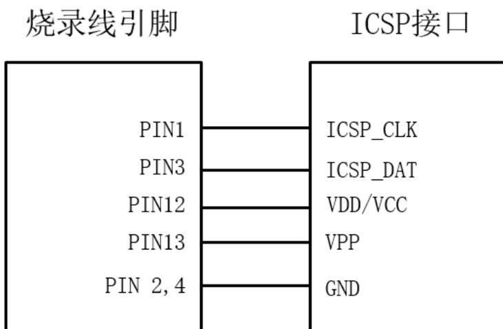
图7.12 S4/S8烧录线与ICSP接口相连接
