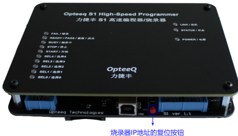
图3.3 烧录器IP地址的复位按钮
