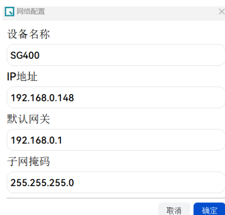
图 5-5 修改 IP 地址
