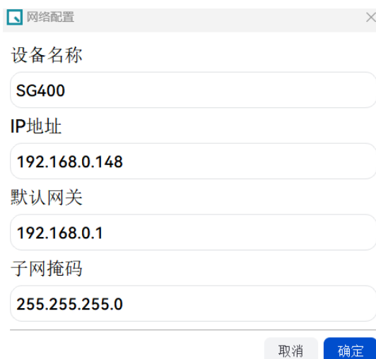
图 5-5 修改 IP 地址
