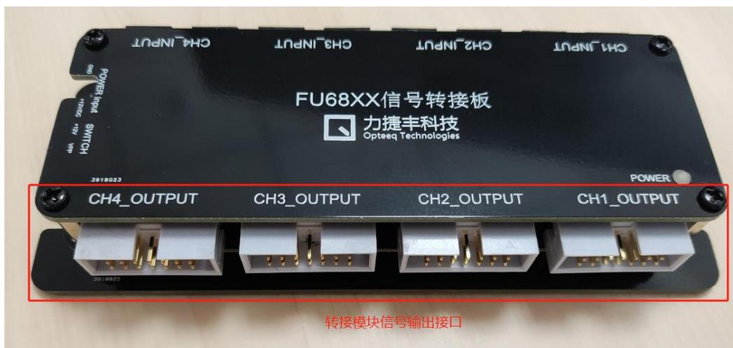
图 2-3 转接模块输出接口图
