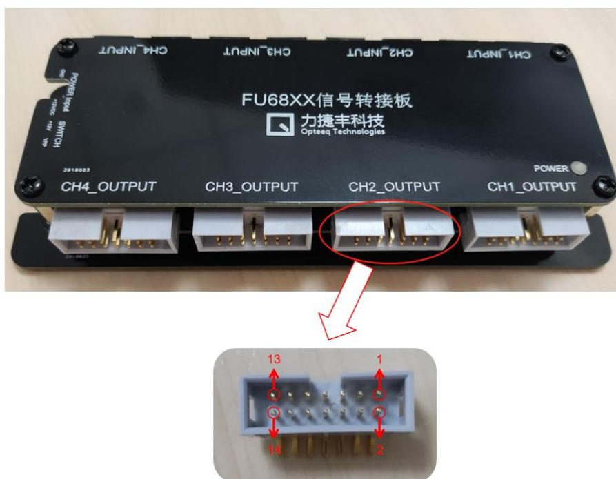
图 2-6 转接模块输出接口 PIN 脚
