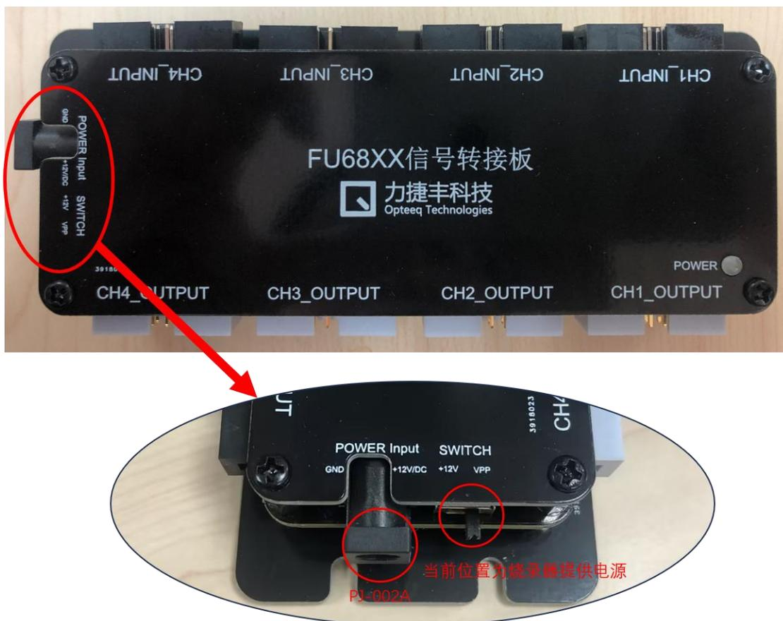
图 2-9 转接模块外部供电电源输入切换开关
