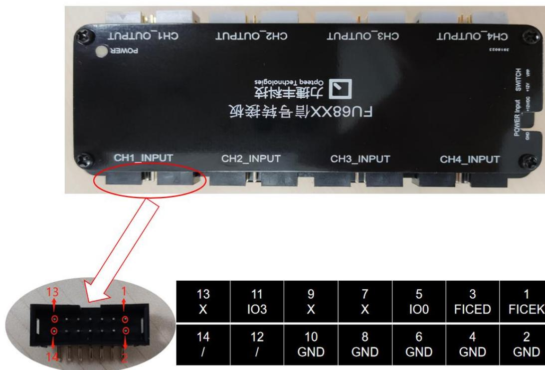
图 2-5 转接模块输入接口 PIN 脚定义
