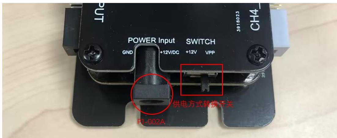
图 2-4 转接模块外部电源输入接口图
