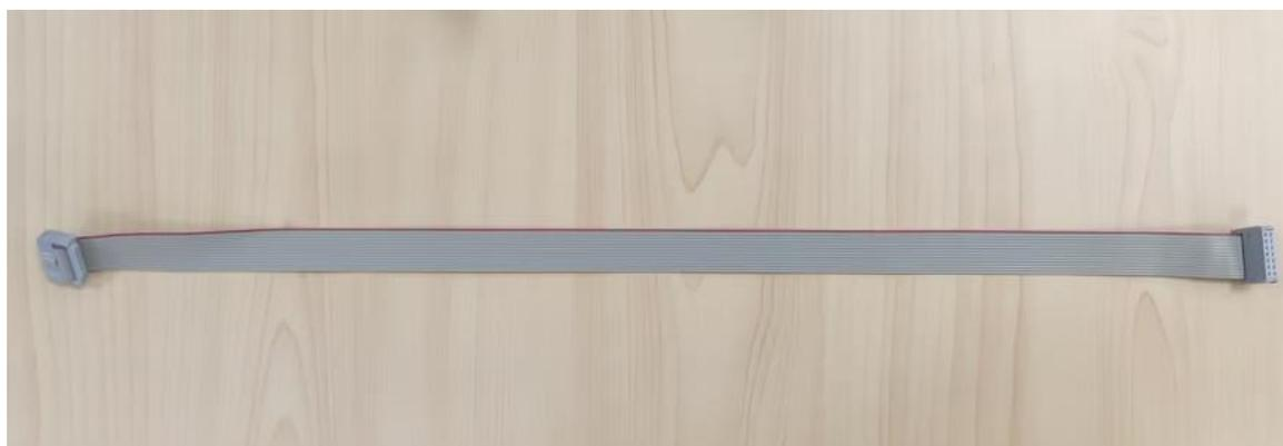
图 2-8 转接模块输出线束
