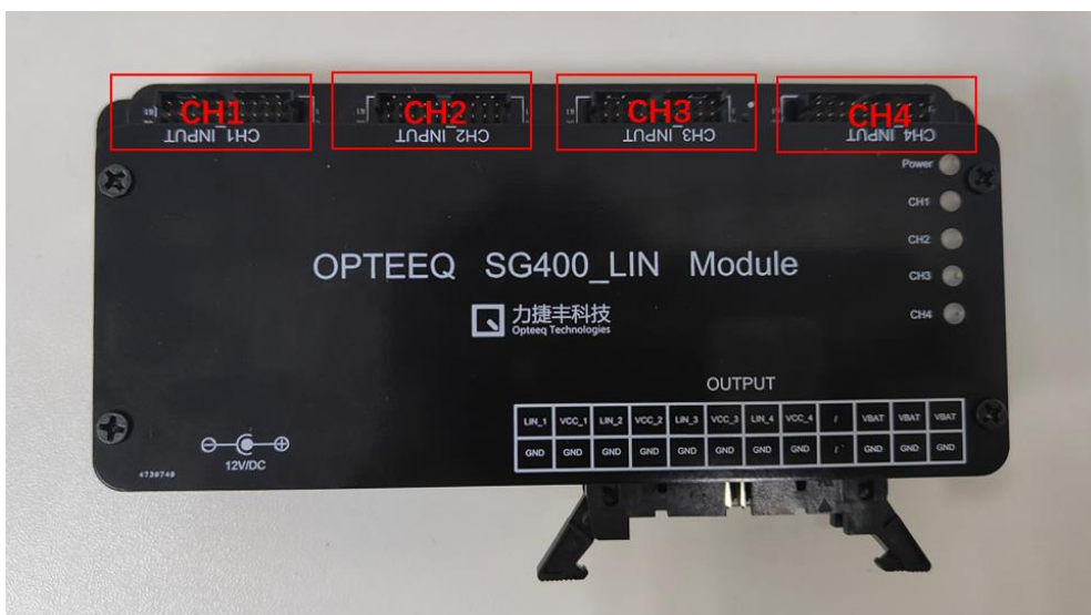
图 2-3 转接模块信号输入接口图
