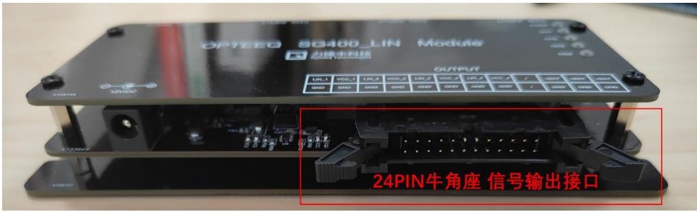
图 2-4 转接模块信号输出接口图
