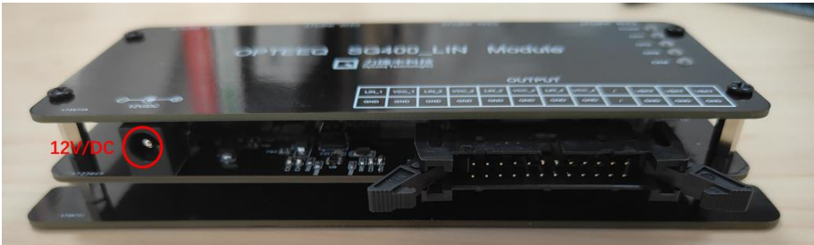
图 2-7 转接模块外部电源输入接口
