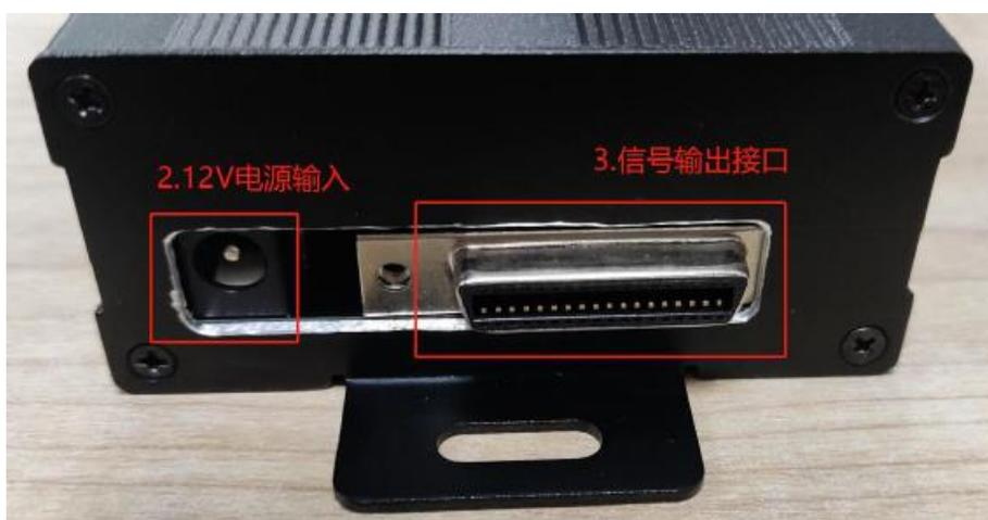
图 2-4 转接模块输出接口
