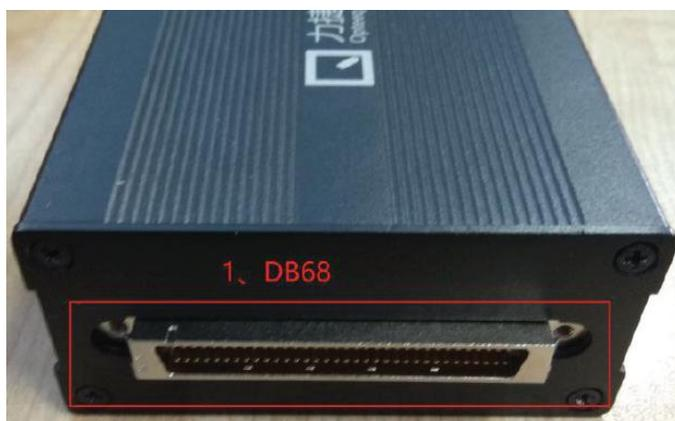
图 2-2 转接模块输入接口
