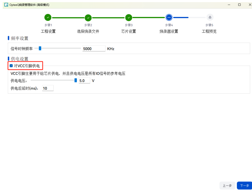
图 6-1 对 VCC 引脚供电
