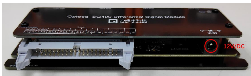
图 2-6 转接模块外部电源输入接口
