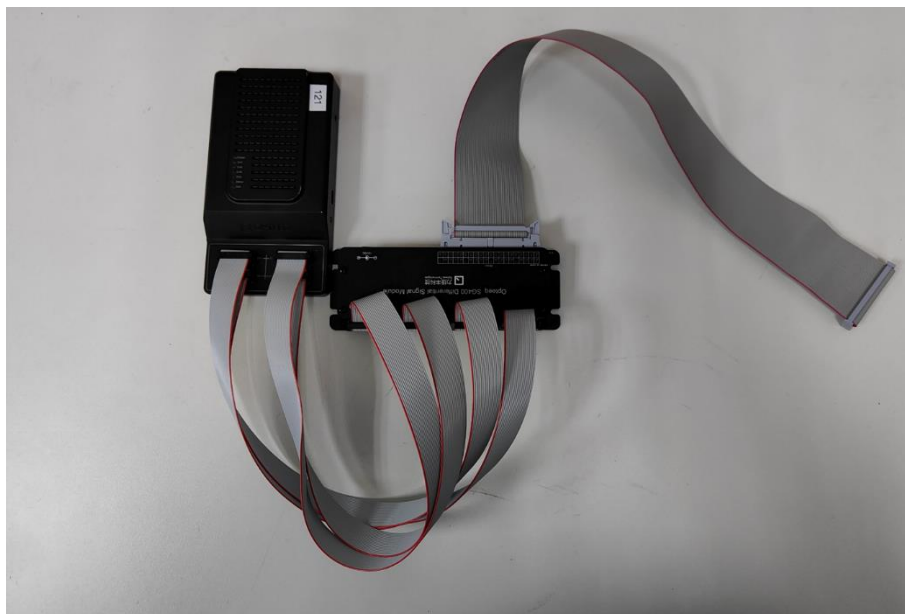
图 3-1 SG400 差分模块与烧录器连接示意图
