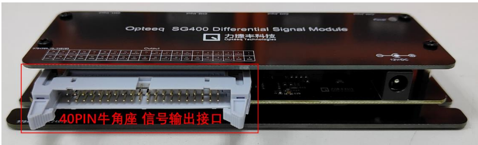
图 2-4 转接模块信号输出接口图
